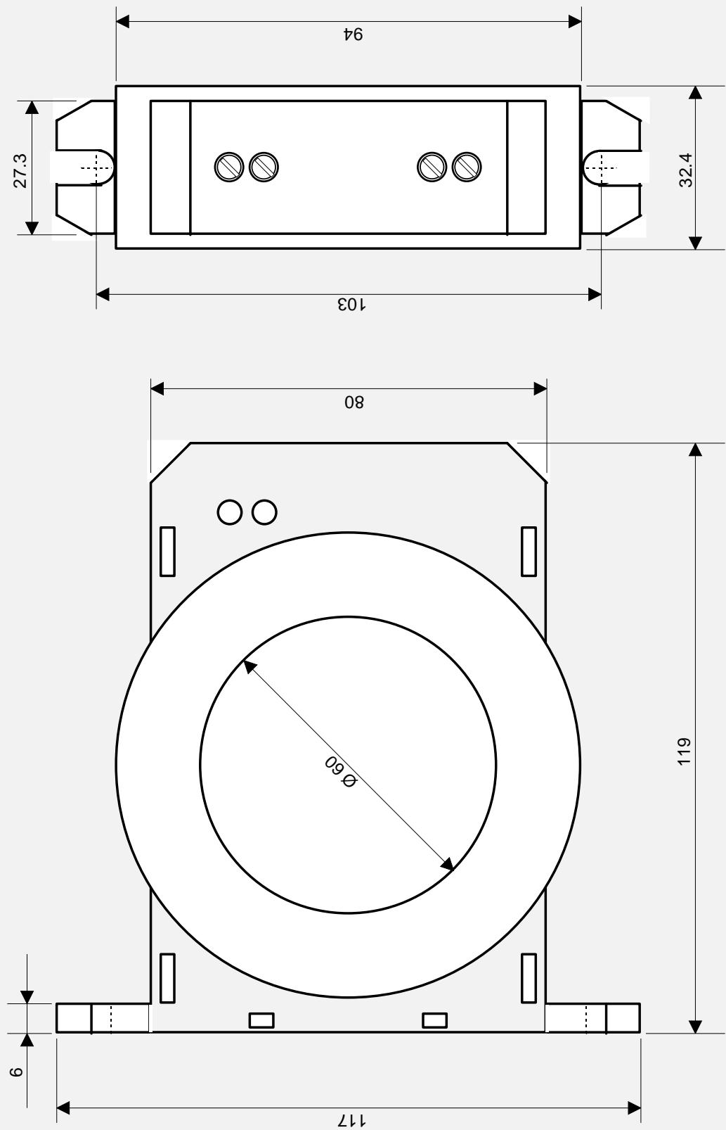
DIMENSIONES TRANSFORMADOR TOROIDAL: TRDF60
